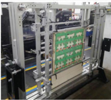
下欄針校板主要功能是實現啤機線外欄針校對，不佔用啤機。節約時間及人力成本，提高效率，降低工人勞動強度。
