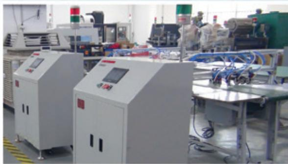
紙袋自動點膠機，裝設在流水線工作平台上，通過光纖感應紙袋到位後開始點膠動作畫軌跡，由旋轉編碼器來測量流水線速度及點膠位置反饋。
