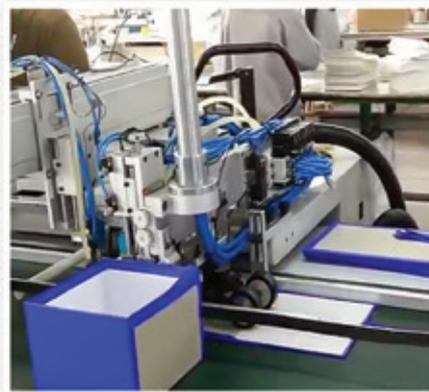
隨線自動點膠機主要採用桌面式，方便使用和搬動。點膠軌跡可調，可設定任意點膠軌跡。
